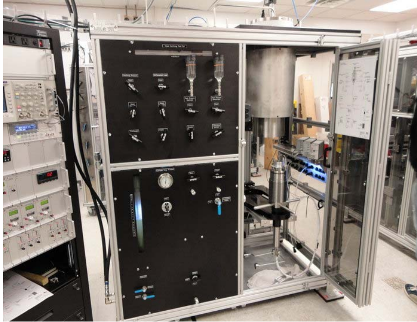
Fig. A: Deformation machine, Autolab 1500c.
